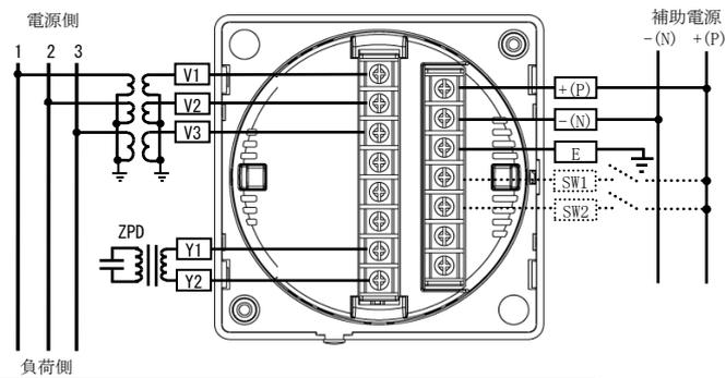
V1-V2 間に必ず電圧を入力してください。
