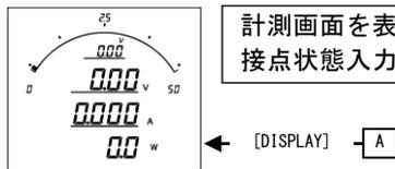
計測画面を表示している状態で、[-]を押し続けると、状態表示画面に切り替わります。接点状態入力信号の状態（通信タイプの場合）を確認出来ます。
