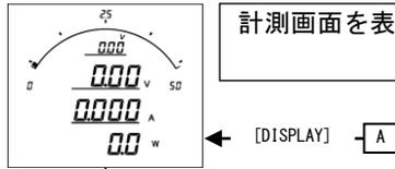
計測画面を表示している状態で、[+]を押し続けると、詳細表示画面に切り替わります。
