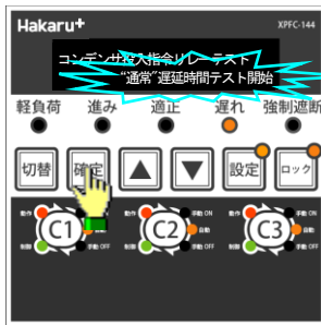
⑤選択したら確定スイッチを長押しします。(点滅が止まり、テストが開始されます)
