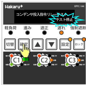
⑦確定スイッチを長押しするとテストが停止します。
