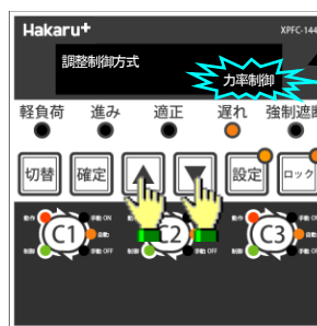
④△・▽スイッチにより設定を切り換えます。 力率制御、又は無効電力制御を選択します。
