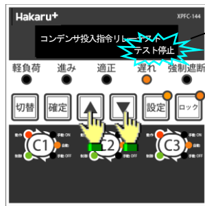
④△・▽スイッチにより設定を切り換えます。“通常”遅延時間テスト開始、又は“短”遅延時間テスト開始を選択します。
