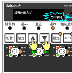
④△・▽スイッチにより設定を切り換えます。 力率制御、又は無効電力制御を選択します。
