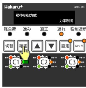
③確定スイッチを押して設定項目を確定させます。 (下部の設定値が点滅を始めます。)
