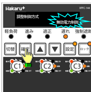
⑤選択したら確定スイッチを押します。 (設定値が更新、記憶され点滅が止まります)
