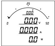
計測画面を表示している状態で、[SET]と[+]を同時に押し続けると、設定画面に切り替わります。
