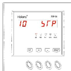
10 通信ストップビット設定：MODBUS 通信のストップビットを設定します
