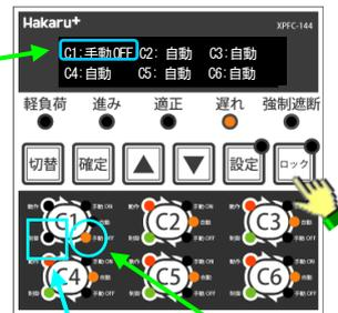
③ スwitchを押したバンクの状態 LED が自動→手動 OFF→手動 ON→自動→…と動きます。また、そのときに変更したバンクの LED およびディスプレイ表示は点滅状態となります。(変更しない場合は点灯状態) コンデンサ状態は確定スイッチを押すまで変更前の状態となります。
