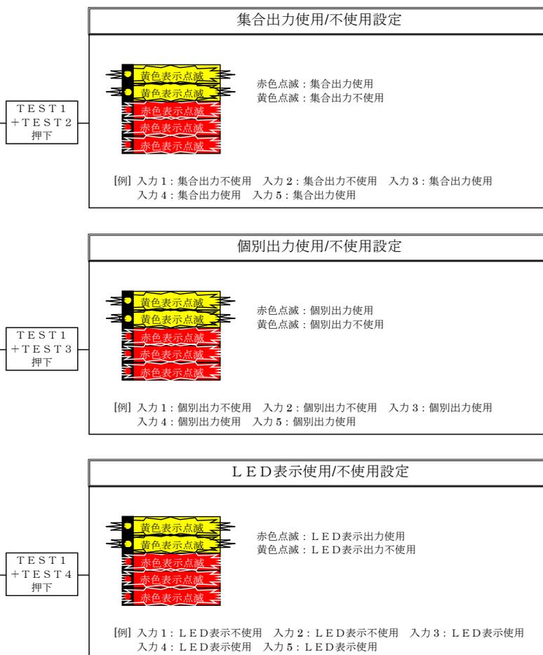
(※注意 1) 設定内容確認画面に切り替える際にはTEST 1とTEST 5を先に押さえてからRESETを押さえるようにしてください。先にRESETを押さえるとブザー鳴動がオフしたり、接点出力がオフします。
