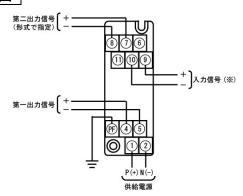
(※)二線式伝送器を接続する時(前面EXスイッチ:ON) アイソレータとして使用する時(前面スイッチ:OFF)
