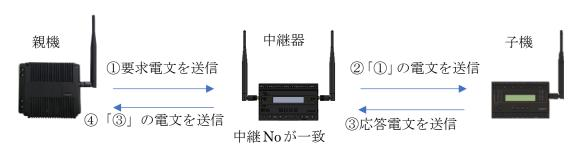
※ 中継器を使用中でも、親機と子機は直接通信することができます。 中継器は親機と子機の直接通信に影響を与えることなく中継動作が可能です。 但し、親機には、どの子機との通信に中継器を使うのかを予め登録する必要があります。
