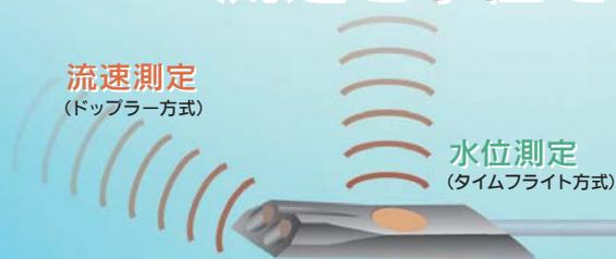
専用水路や堰を設ける事なしに、センサを水路の底に固定し、配管径 または水路幅を入力するだけで流量測定が可能です。実際の流速と水位をリアルタイムに計測しますので高精度な測定が可能となります。
