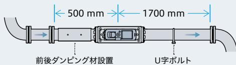
Lminは387 mm、Lmaxは1500 mmのため、上流側は前後ダンピング材を設置すると使用できます。下流側は前後ダンピング材を設置する必要はありません。このため、前後ダンピング材の必要数は1セットとなります。
