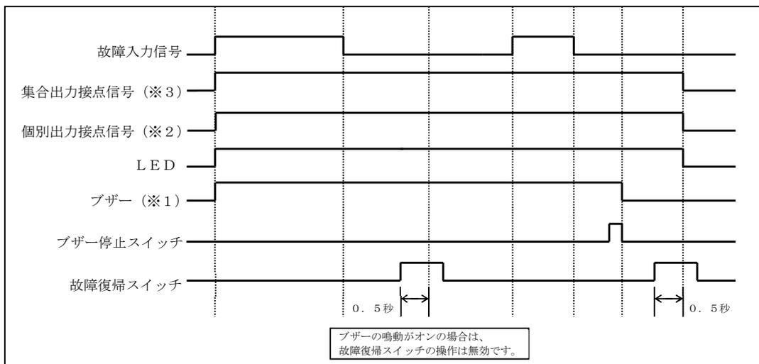
※ブザー鳴動オフ後で故障信号の入力がオンの時、その故障項目に対する故障復帰スイッチの操作は無効です。（接点出力、LED表示をオフにすることはできません。）
