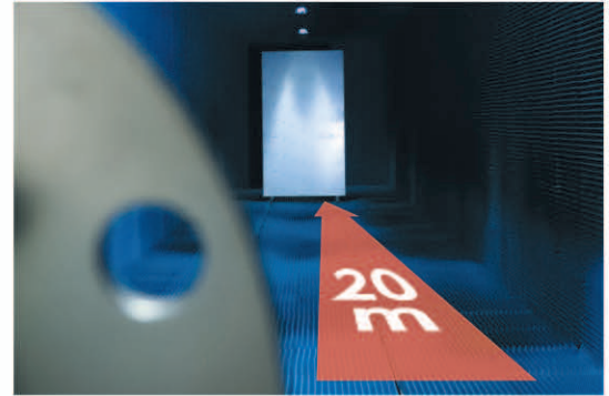
写真「Waveラボ」内の電波暗室
