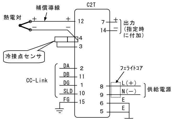
(\*) 冷接点センサは、ソケットに組み付け時、H寸法の上側に 7mm 突き出ます。R 热電対のときは付属しません。
